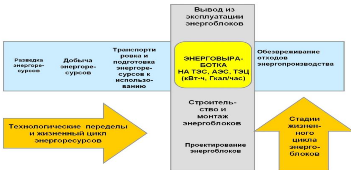
Рисунок 2 – Модель отраслевого производства замкнутого цикла на примере атомной энергетики (модель двухкомпонентной атомной энергетики)
